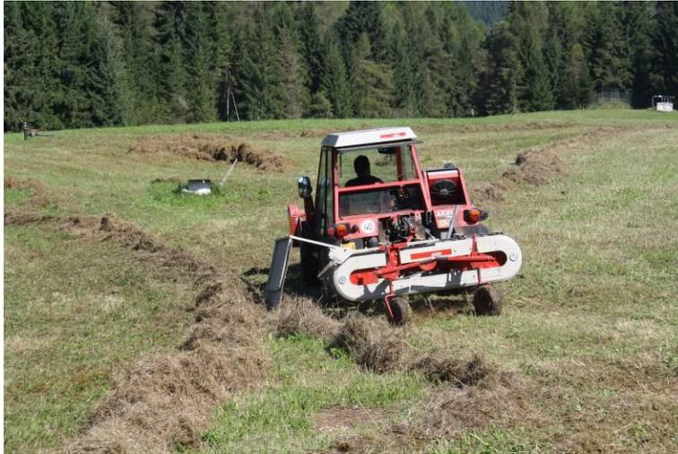
Foto 6: la successiva operazione di ranghinatura e rastrellatura
