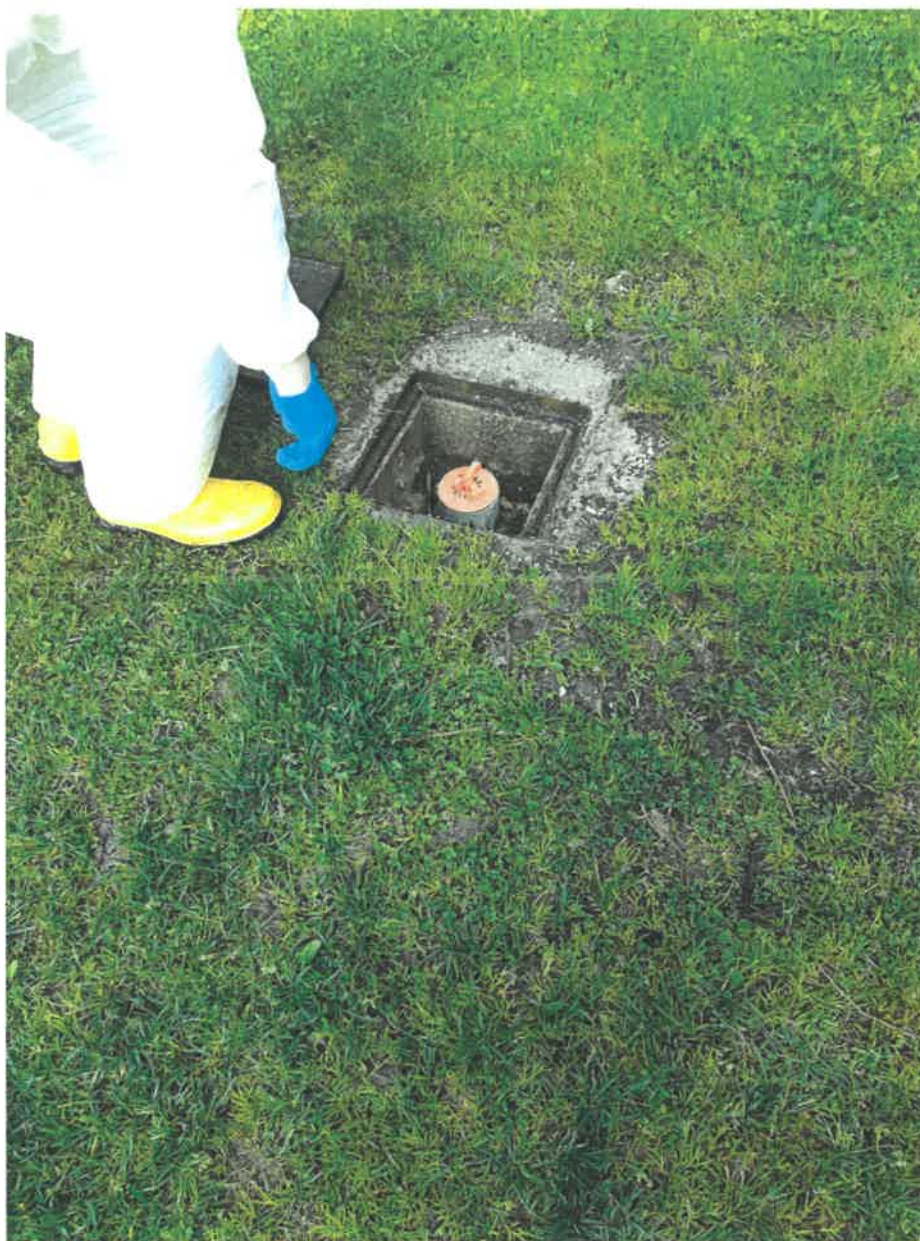
Foto 14: operazioni di prelievo delle acque sotterranee
