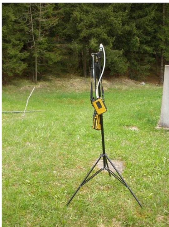
Foto 9: campionamento delle emissioni in atmosfera
