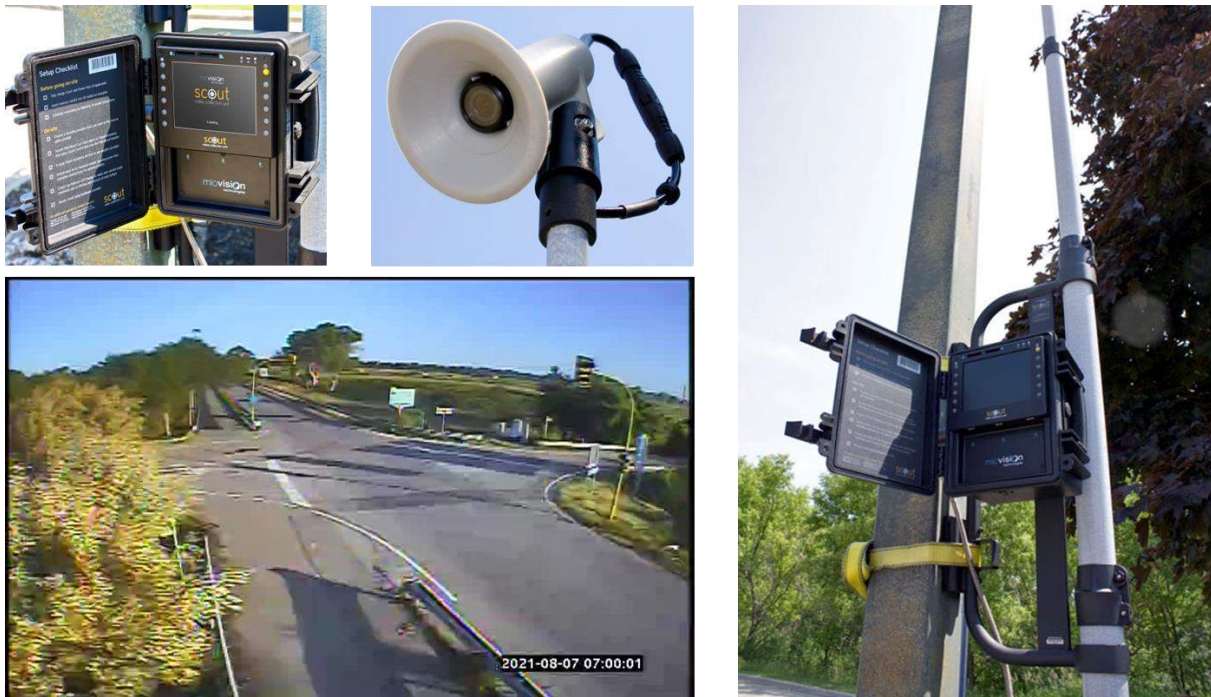
Figura 113 Sistema di acquisizione video e decodifica automatica delle immagini mod. MIOVISION
