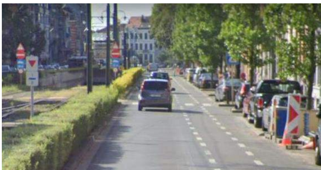
Figura 444 Il franco rispetto alla sosta è ampliato riducendo l'ampiezza della corsia ciclabile (Bruxelles)
