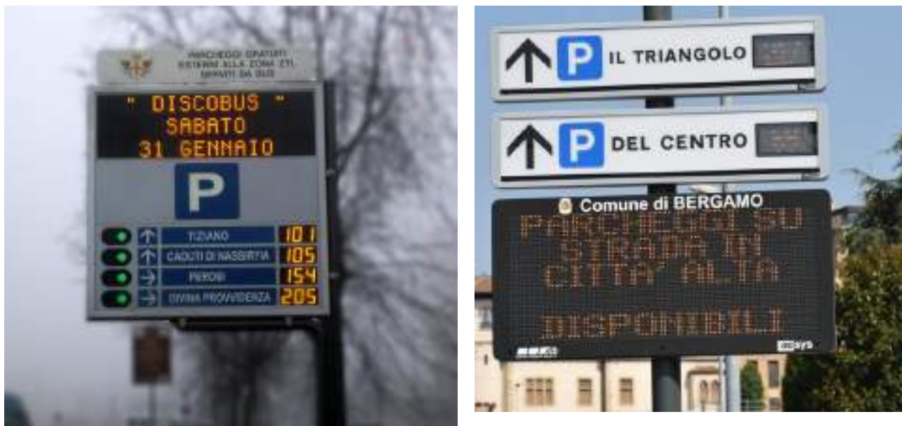
Figura 470 Pannelli a Messaggio Variabile per l'indirizzamento della sosta
