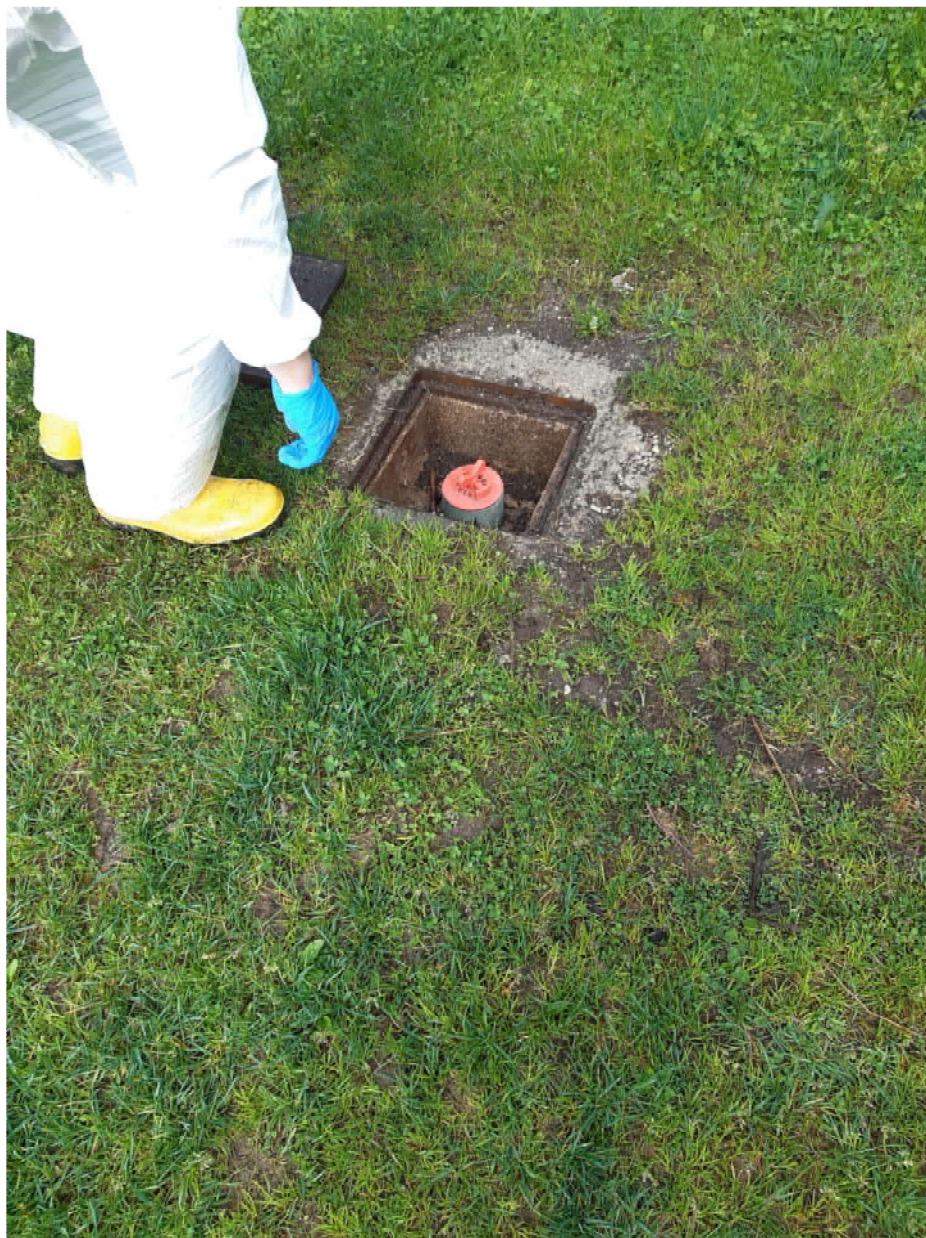
Foto 14: operazioni di prelievo delle acque sotterranee
