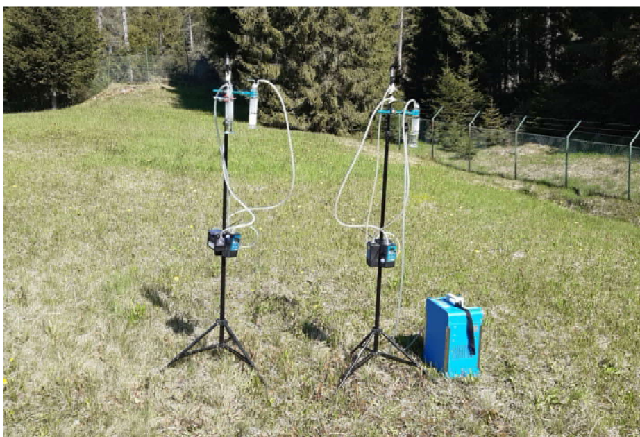
Foto 16: operazioni di campionamento dell'aria
