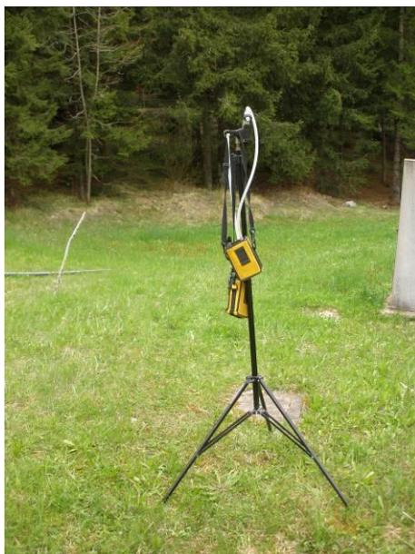
Foto 13: campionamento delle emissioni in atmosfera
